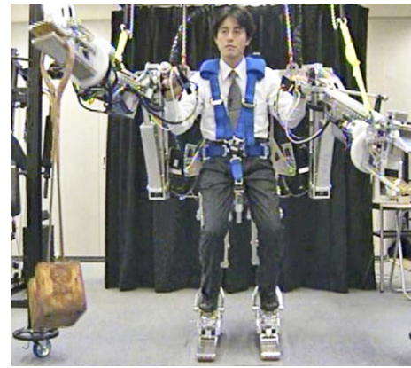
▲全身型パワー増幅ロボット（パワーローダー）
