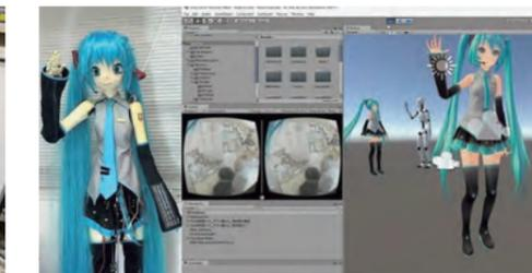
▲写真2 モーションキャプチャによる遠隔地のロボットの制御
