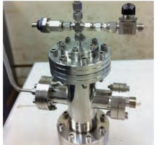
ランキンサイクル用作動流体の熱特性測定装置
