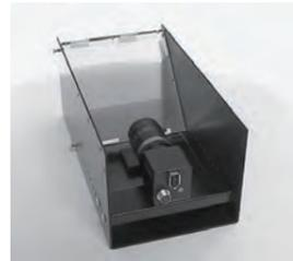
▲写真2 透明板を使った単眼距離計測装置
