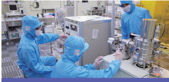
機械実験・電気電子実験：精密機械工学に関する各種実験科目について、実験と教員との試問を繰り返し、理解を深めます。写真は、クリーンルーム内で微細パターンを製作している様子です。
